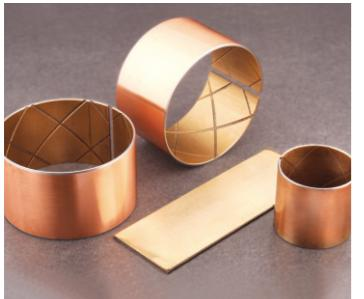
TF-1 双金属轴承，是以低碳钢板为基体材料，用特殊工艺表面烧结 CuPb10Sn10+C 材料的钢铜合金新一代改良产品。做成衬套后，具有 JF-800 双金属轴承的耐压、耐磨性能，经过石墨散嵌后达到了无给油润滑的作用。在少油条件下摩擦系数较少，完全防御咬轴的现象，该产品适用于橡胶轮胎模具的导向部位，升降设备的滑动部位，水轮机的高速滑动部们等高温、高速、不能长期加油的场合。
