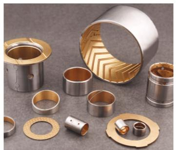
JF-800双金属轴承，是以低碳钢板为基体材料，表面烧结CuPb10Sn10或CuSn6Zn6Pb3材料的钢铜合金产品。该产品是双合金轴承中承载能力最强的一种，重型车的平衡桥衬套、垫片；推土机的从动轮；汽车钢板衬套，均使用该产品。它是一种用途很广的高载低速滑动轴承。
