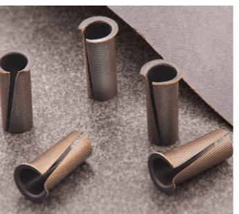
FR四氟软带轴承以青铜丝网为基体，通过特殊工艺。表面轧制聚四氟乙烯（PTFE）和其它填充减磨材料的混合物。它具有较低的摩擦系数，较好的耐磨特性。由于它的柔软性能好，可以做钢与钢对磨的隔膜，实现无间隙、无噪音、无油润滑无保养、无污染的理想目的。目前，产品已广泛应用在纺织机械关节轴承、汽车门铰链及仪器仪表、汽车操纵杆等场合。
