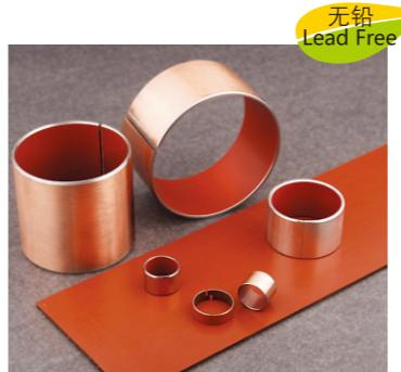
SF-1D液压专用轴承，是在SF-1P的基础上结合油缸及减震器工作原理而设计的一种新型材料，在无油的条件下显得更耐磨，该产品除具有SF-1P的优点外，特别适用于往复频繁的大侧向力场合。其性能与国外DP4相似，目前该产品逐步替代SF-1P产品，适用于汽车、摩托车减震器以及各种液压缸等领域。
