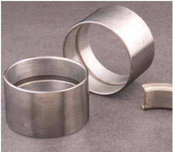
JF-20高锡铝轴承该产品以优质低碳钢板为基体，表面采用特殊工艺轧制铝锡合金。它有中等抗疲劳强度和承载能力，良好的耐腐蚀性，较好的轴承表面性能，产品适用于内燃机主轴和连杆轴承、压气机、制冷机用轴承。
