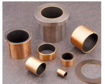
SF-1B青铜基轴承，是以锡青铜为基体，中间烧结青铜球形粉，表面扎制PTEE和耐高温填充材料而成。它具有很高的安全系数，在连续工作不能停机修理的场所和高温不能加油的场所特别适用。目前已广泛应用在冶金钢铁工业，连铸机方坯滚道、高温炉前设备，水泥灌浆泵和螺旋式输送机上。它可以在外部组合钢套，也可以制成翻边，达到端面、内孔同时摩擦使用的效果。桥梁支座滑动部位就是采用SF-1B耐磨层加厚的产品以取代纯PTFE板，达到130N/mm<sup>2</sup>承载使用的要求。
