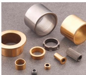
Fu 基含油轴承是以锡青铜粉末为料经过模具压制，在高温中烧结后整形而成。它的基体有细微、均匀的孔隙，经润滑油真空浸渍后形成含油状态。该产品具有短期不加油润滑，使用成本低，内外径尺寸可变化等特点，适应于中速低载负的场所使用。产品已广泛应用于家用电器、电动工具、纺织机械、化工机械、汽车工业和办公设备中及一些普通机械场合使用。
