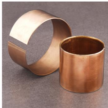
TF-1B 青铜合金轴承，是以铜基板为基体材料，用特殊工艺表面烧结 CuPb10Sn10+C 材料的钢铜合金新一代改良产品。做成衬套后，具有 JF-800 双金属轴承的耐压、耐磨性能，经过石墨散嵌后达到了无给油润滑的作用。在少油条件下摩擦系数较少，完全防御咬轴的现象，该产品适用于橡胶轮胎模具的导向部位，升降设备的滑动部位，水轮机的高速滑动部们等高温、高速、不能长期加油的场合。
