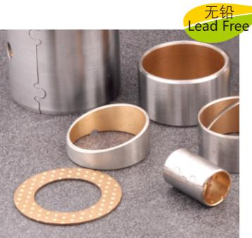
JF-930无铅双金属轴承是一种环保型的双金属轴承，它是以低碳钢板为基体，表面烧结CuSn6.5P0.1材料的钢铜合金产品。产品具有较高的疲劳强度和承载能力，较好的滑动性能，在许多场合能够替代含铅的双金属轴承或铜套。
