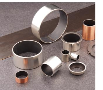
SF-1无油润滑轴承，是以钢板为基体，中间烧结球形青铜粉，表面轧制聚四氟乙烯（PTFE）和铅的混合物，是卷制而成的滑动轴承。它具有摩擦系数小，耐磨、抗腐蚀性好和无油润滑的特点。使用该项产品能降低成本、缩小机械体积、避免咬轴现象和降低机械噪音等优点。产品已广泛应用于各种机械的滑动部位，如印刷机、升降机、纺织机、烟草机、健身器、液压搬运车、微电机、电磁阀、汽车、摩托车与家林机械等。
