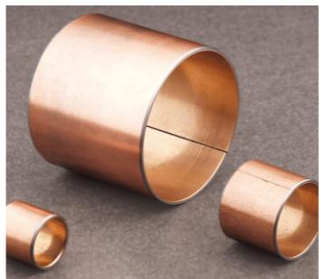
JF-720双金属轴承以优质低碳钢板为基体，表面烧结铅锡青铜合金，经多次烧结轧制而成。它有很高的抗疲劳强度、承载能力、抗冲击能力、耐腐蚀、有较好的轴承表面性能，产品适用于高速、重载的内燃机主轴和连杆轴承。
