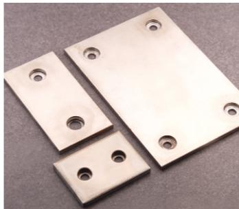
TF-2H 双金属滑板滑块，是以低碳钢板为基体材料，采用特殊工艺表面烧结 CuSn5Ni20Fe38+C 材料的钢铜合金新无铅改良滑板、滑块产品。做成滑块、滑板后应于露天使用的铁路扳道滑块，既耐磨又可不保养，也适用于汽车模具滑块和高温的冶金设备上使用。
