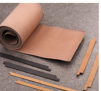
FD含铜四氟带是聚四氟乙烯（PTFE）为主要原料，填充铜粉等耐磨材料，经模压制烧结而成，具有良好的耐磨性。其抗拉强度可以满足单体活塞环使用条件。摩擦系数低，在有油润滑和无油润滑条件下都能正常使用，是汽车减震器、活塞环的最佳选择。目前，一汽奥迪和大众桑塔纳、富康轿车都采用此产品，它能长期保持较低的摩擦系数。
