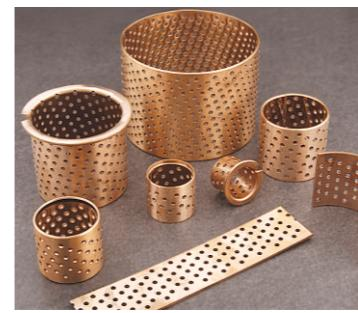
FB092青铜轴承,是以青铜材料为基体,加工均匀有序的注油孔,经卷制而成的薄壁轴承,在装配后注入润滑油脂,再配置端面密封使用。该轴承具有存油量大、安装方便、设计机子小的优点，而且可以取代铜套便用，能大大地降低成本。目前该产品已应用于输送机、升降机、卷扬机、校平机等中载、低速地场合。
