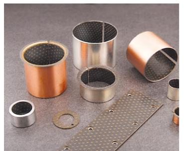
SF-2边界润滑轴承，是以钢板为基体、中间烧结球型青铜粉，表面轧制改性聚甲醛（POM），并含有储油坑。它适用于常温条件下低速重载场所，取代于传统铜套，既降低成本又延长使用寿命。特殊情况下，在轧钢机上使用，又能节省加油频次，简化更换程序。该产品已广泛应用于汽车底盘、锻压机床、冶金矿山机械、工程机械、水电、轧钢行业等领域。
