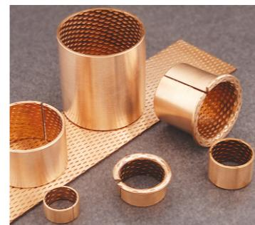
FB090青铜轴承采用特殊配方的高密度铜合金带材料为基体，表面可以按用户要求轧制菱形或半球形油穴、油槽。具有密度高、承载压力大、耐磨性能好、使用寿命长等优点，以取代传统的铸造铜套，可以缩小机械体积，降低成本。FB090已广泛应用于起重机械、建筑机械、汽车拖拉机底盘、机床工业及采矿机械中，还可以制成轴瓦、翻边套、止推垫片和球碗等形式。
