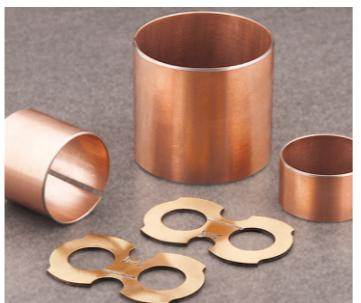
JF-700双金属轴承该产品以优质低碳钢板为基体，表面烧结铅锡青铜合金，经多次烧结轧制而成。它有很高的抗疲劳强度、承载能力、抗冲击能力、耐腐蚀、有较好的轴承表面性能，产品适用于高速、重载的内燃机主轴和连杆轴承。
