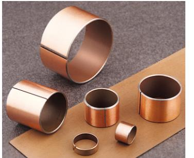
SP-1P 往复运动轴承是在SF-1材料的结构基础上，根据往复运动的特殊工况条件下而设计的新颖的配方产品，其性能与国外DD2相似。具有断油条件下润滑能力强、耐磨性能好、保持油膜清晰等优点，该产品能较好地保持对磨轴表面不受磨损。目前该产品已广泛地运用于汽车减震器、摩托车减震器、各种液压油缸、液压马达、气动元件等领域。
