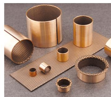
FB09G青铜固体润滑轴承是以青铜材料为基体，再埋入特殊固体润滑剂制作成的新颖滑动轴承。由于高强度承载的合金材料作基体，理想的并经过严格选别的高分子填充材料为耐磨剂，合理的螺旋角度菱形块状均布的润滑面，润滑面积达25%，因此，能发挥超群的低摩擦，良好的润滑性和抗磨耗性。产品以适用于汽车起动电机、发电机、升降机、吊车及冶金机械等行业。
