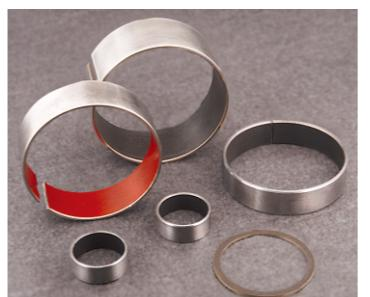
SF-1S不锈钢耐腐蚀轴承，是以不锈钢材料为基体，中间烧结耐腐蚀合金粉末，表面轧制以聚四氟乙烯为主的耐腐蚀材料。它具有耐油、耐酸、耐碱、耐海水和耐磨损的特点，表面PTEE材料不含铅成份。在食品饮料机械、化工中度酸碱流量的泵阀、制药机械、印刷机械、化工机械、海洋工业耐腐蚀滑动部位最适合使用。
