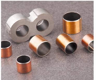
SF-1T齿轮油泵专用轴承是在SF-1材料的结构基础上，根据齿轮油泵的高PV值工况条件而设计推出的特殊配方产品。产品具有特殊的抗疲劳冲击优点。适应的油泵压力：16-25MPa，线速度3.5-5M/S。产品具有特殊的抗疲劳、抗冲击的优点载流体润滑滑界下PV值达120N/mm<sup>2</sup>·m/s。是各种齿轮油泵、柱塞泵、叶片泵的最佳选择。本公司产品长期为榆次液压有限公司齿轮油泵配套，质量水平处于国内领先地位。
